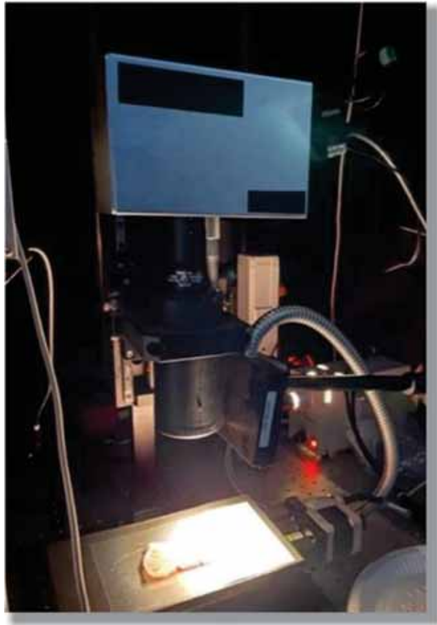
चित्र 2. मैकेरल नमूनों की हाइपरस्पेक्ट्रल छवियों के लिए अधिग्रहण प्रणाली (चित्र सौजन्य: रयु और अन्य, 2024)
