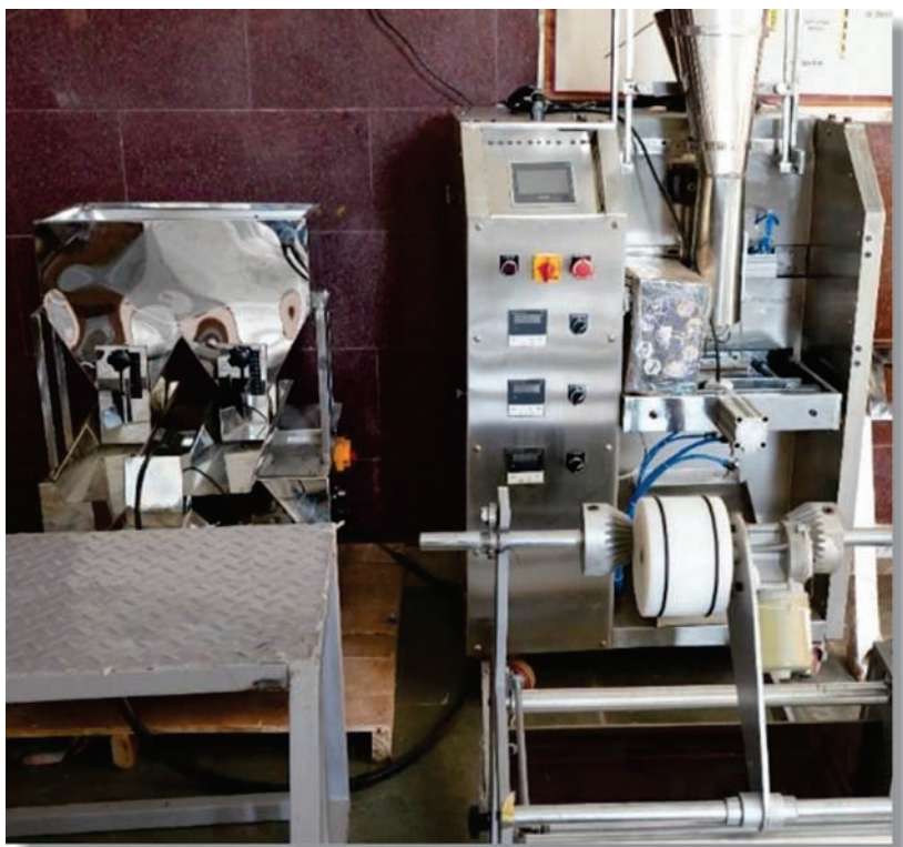
चित्र 8: फॉर्म, फिल और सील मशीन
